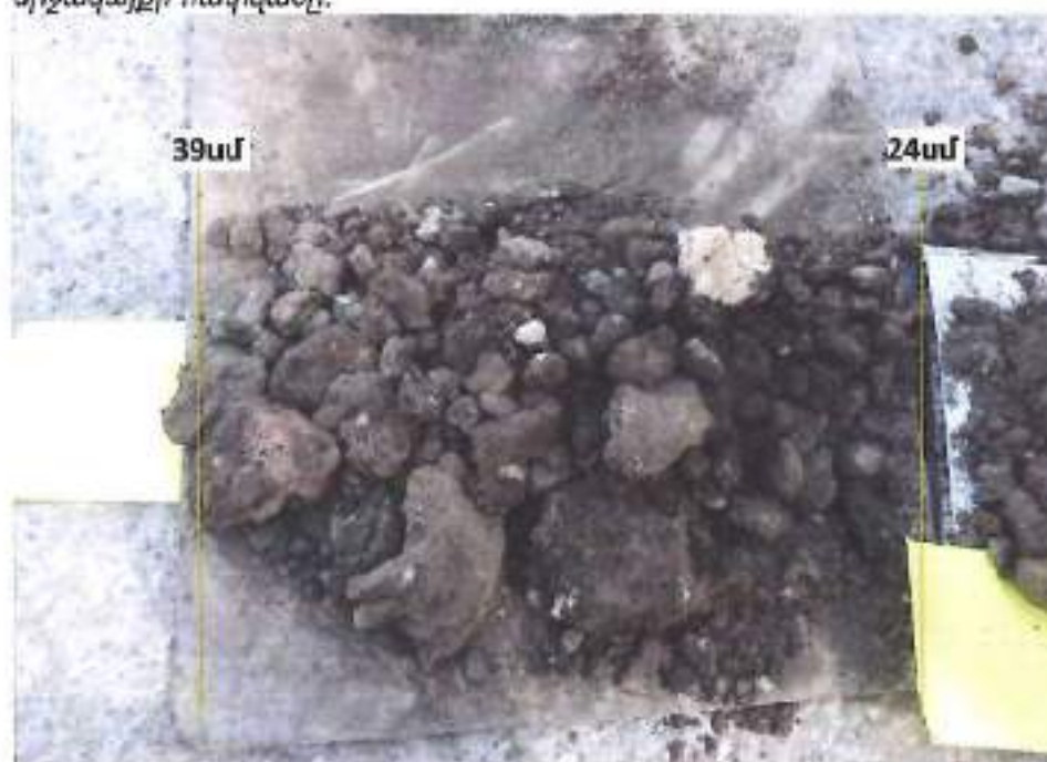
Նկար 2գ. պարկերված է N1 պիկետի հորաքանցքի հորաքահանուկի 24-ից 39սմ խորության միջակայքի հատվածը:
