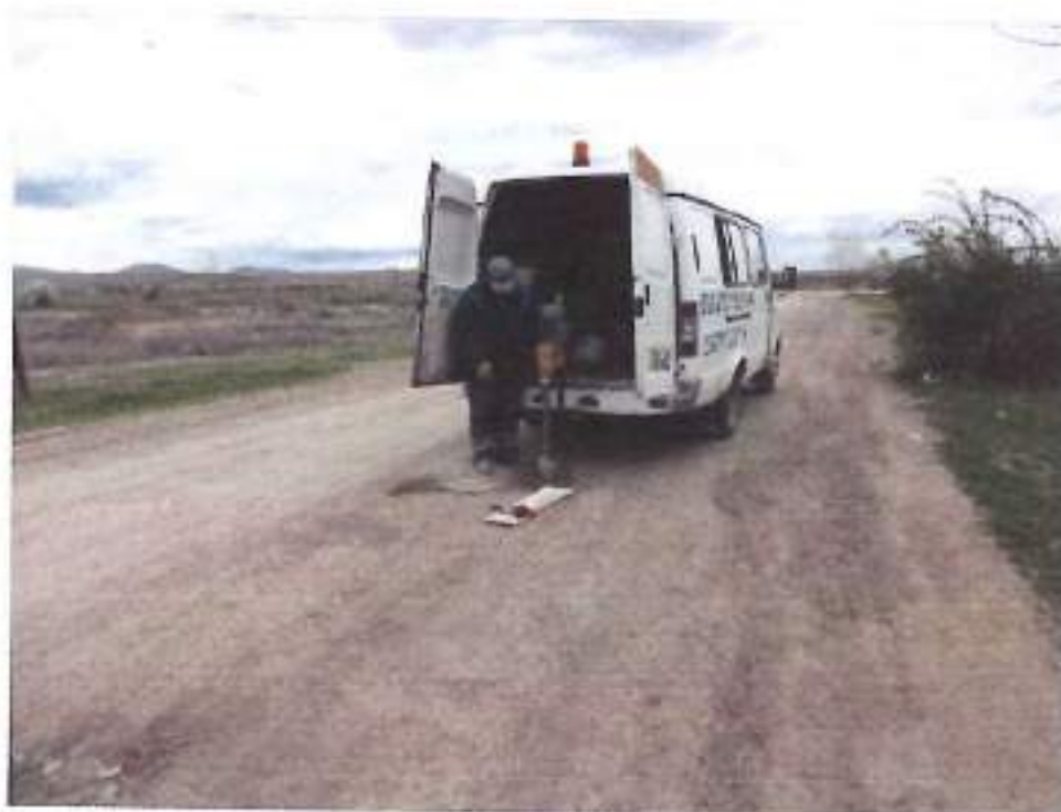
Նկար 16. Պատկերված է ուժեղ քայքայված առֆալորեպոնե ճանապարհը 6-րդ պիկետի փարածքում և հորատման վայրը:
