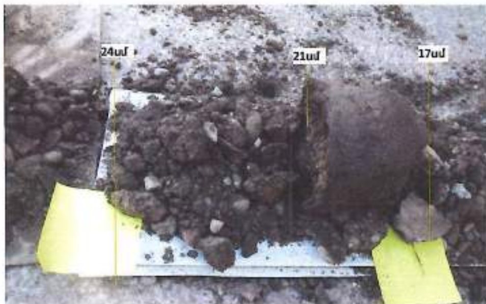
Նկար 2բ. պարկերված է N1 պիկետում հորարված հորաքահանուկի 17-ից 24սմ խորության միջակայքի հատվածը:
