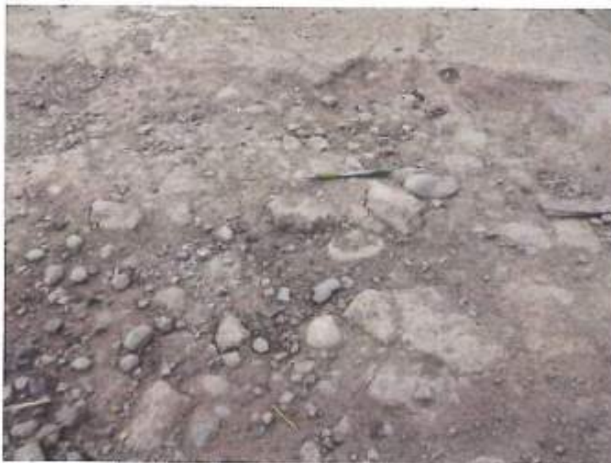
Նկար 21. Պատկերված է Ց-րդ պիկետի տարածքում ուժեղ քայքայված ապօրհնությունի փոսը, որի մեջ ավազա-գլաբարային գրունտ է լցված:
