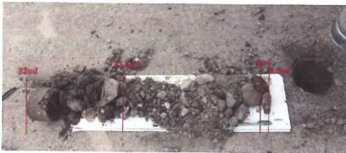
Նկար 19. Պարկերված է 7-րդ պիկետի հորատանցքի հորատահանուկը:
